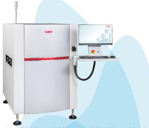
Dizgi işlemi tamamlanan elektronik kartların üzerindeki komponentlerin varlıkları, markalamaları, lehimlemeleri vb. gibi durumlarını optik olarak kontrol eden makinedir.
