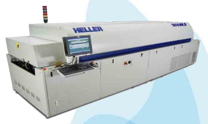
Reflow lehimleme fırını ile uyarlanabilir sıcak hava veya termal radyasyon iletimi sayesinde krem lehim kullanılarak elektronik kartın üzerindeki komponentler uygun ve hızlı şekilde lehimlenir.
